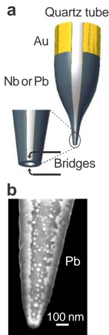
**Fig. 1. SQUID-on-tip devices<sup>5</sup>.**
