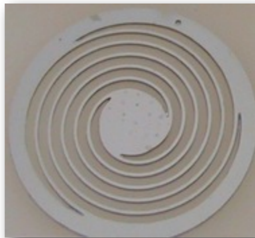
flap: Au layer 10 μm
