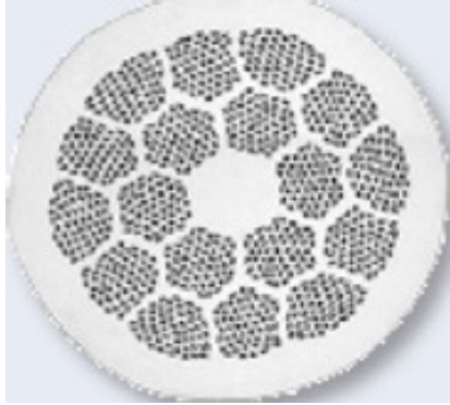
Bi-2212 round wire Larbalestier et al, Nature Mater Jiang et al IEEE TAS 29, 6400405 (2019)
