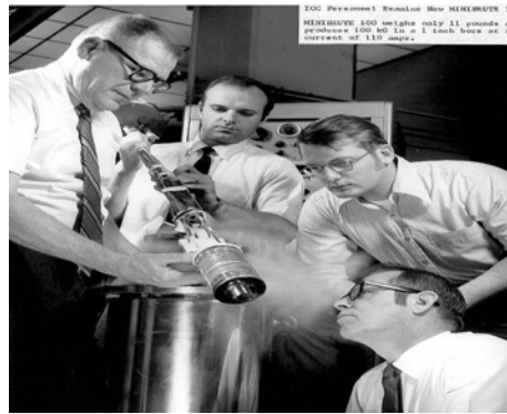
Fig. 21. E. Mains, T. Haller, K. Pickard, E. Knopf testing smallest 10 T magnet.
